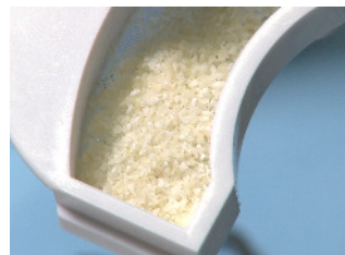
Abb. 7 und 8: Das gewonnene, zerkleinerte und gefilterte Material wird mit der Cleanser®-Flüssigkeit für 10 Minuten versetzt. Beim „Cleanser“ handelt es sich um Natriumhydroxid mit 20 % Ethanol.
