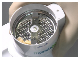
Abb. 4-6: Die Kammer wird sicher verschlossen, der GRIND-Vorgang auf 3 Sek. und „SORT“ auf 20 Sek. eingestellt und auf „Start“ gedrückt! Dem lauten Geräusch des Zermahlens folgt ein vibrierendes Geräusch, bei dem in zwei Filterkammern das Granulat nach Größen sortiert wird.
