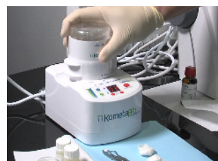
Abb. 4-6: Die Kammer wird sicher verschlossen, der GRIND-Vorgang auf 3 Sek. und „SORT“ auf 20 Sek. eingestellt und auf „Start“ gedrückt! Dem lauten Geräusch des Zermahlens folgt ein vibrierendes Geräusch, bei dem in zwei Filterkammern das Granulat nach Größen sortiert wird.
