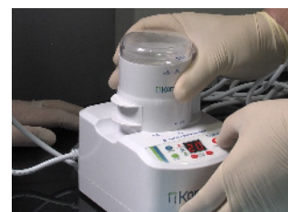
Abb. 4-6: Die Kammer wird sicher verschlossen, der GRIND-Vorgang auf 3 Sek. und „SORT“ auf 20 Sek. eingestellt und auf „Start“ gedrückt! Dem lauten Geräusch des Zermahlens folgt ein vibrierendes Geräusch, bei dem in zwei Filterkammern das Granulat nach Größen sortiert wird.
